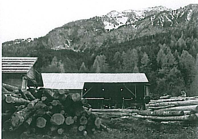
La scierie Roman, une scierie de montagne, avec au premier plan des grumes de mélèze écorcées droites, ensuite le bâtiment abritant l'écorceuse, et au fond le hangar où se trouve la scie de tête.
